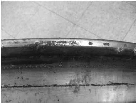
Gambar 13-37 Lubang-lubang kecil (Pitting) yang dapat diterima
