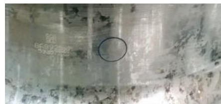
Gambar 13-5 Indikator panas versi 2 pada lubang jatuh pelek, dekat dengan nomor seri dan lubang katup
