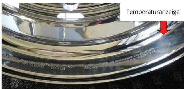
Abbildung 13-2 Hitzeindikator am Radflansch
