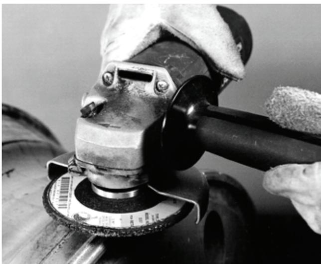
Abbildung 13-33 Winkelschleifer
