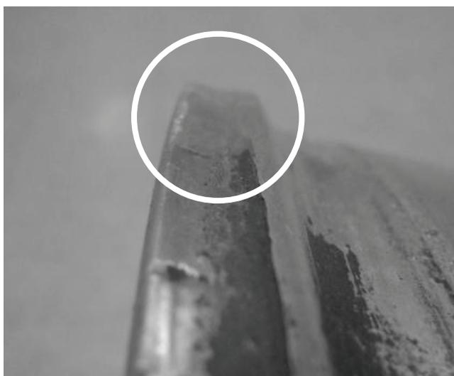
Abbildung 13-36 Scharfe Kante entfernt
