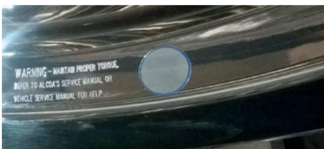
Fotografía 13-4 Indicador de calor versión 2 en el borde de la llanta
