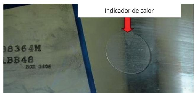
Fotografía 13-3 Indicador de calor en el centro hundido de la llanta
