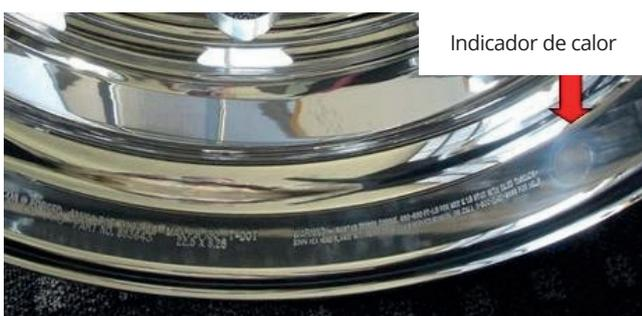
Fotografía 13-2 Indicador de calor en el borde de la llanta
