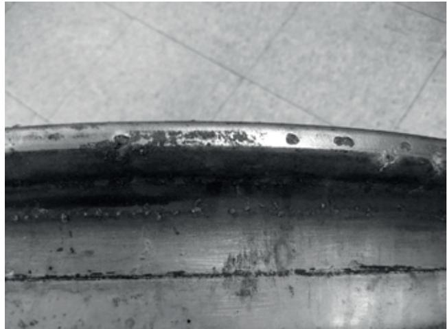
Fotografía 13-37 Desgaste y corrosión por picaduras aceptable
