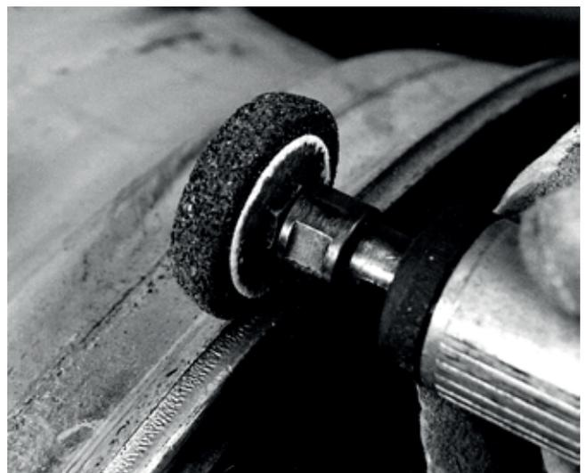
Fotografía 13-32 Lijadora eléctrica o neumática.
