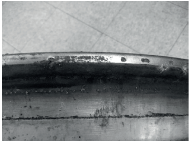
Kuva 13-37 Hyväksyttävä kuluma ja pistekorroosio
