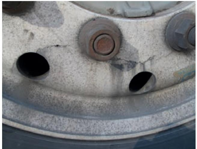
Inspeção minuciosamente a área de contato do cubo / tambor para ver se há rachaduras ou outros danos.
