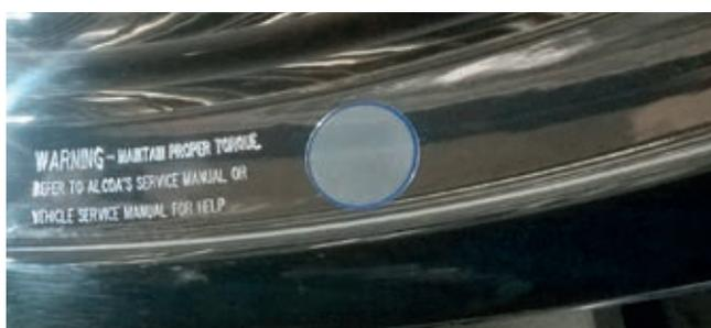
Foto 13-3 Indicador de calor na cuba da roda
