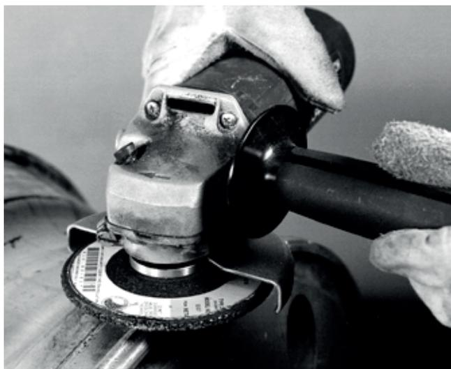
**Εικόνα 13-33 Γωνιακός λειαντήρας**
