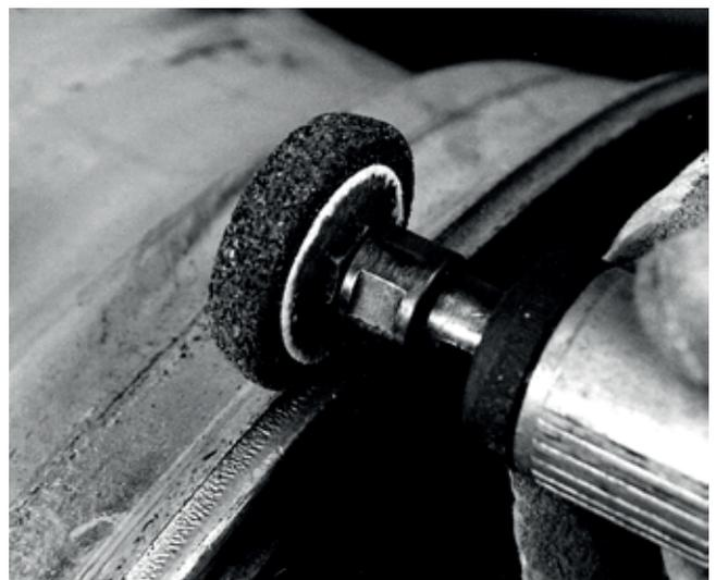
Εικόνα 13-32 Αέρας ή ηλεκτρικός λειαντήρας
