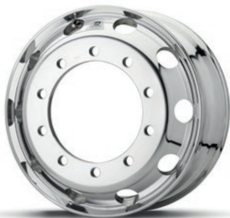
Afbeelding 13-18 Wiel dat dubbel gemonteerd kan worden.
