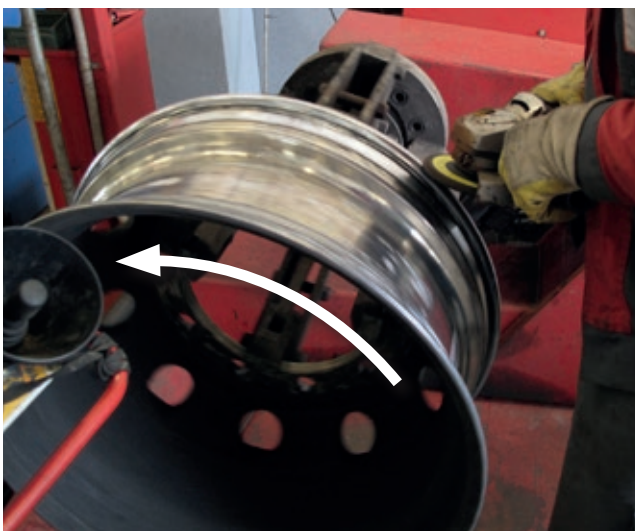
Afbeelding 13-34 Haakse slijper, tips
