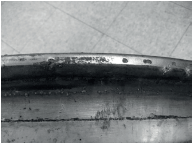
Afbeelding 13-37 Aanvaardbare slijtage en putjes
