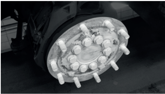
Afbeelding 13-45 Naaf, doorgaand rond in omtrek
