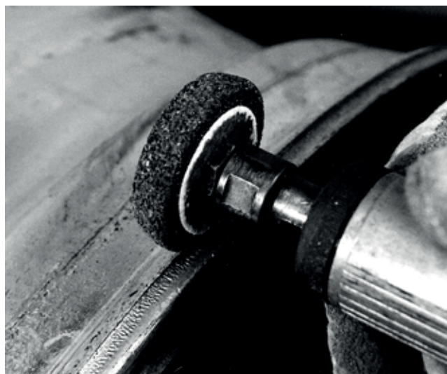
Afbeelding 13-32 Perslucht - of elektrische slijptollen Nog een snelle en effectieve methode om de scherpe kant, veroorzaakt door slijtage van de velgrand, te verwijderen. Wees voorzichtig, want slijpschijven en -gereedschappen kunnen "dichtslibben" met het aluminium dat wordt verwijderd. Vermijd groeven in het wiel.
