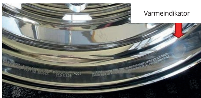
Bilde 13-2 Varmerindikator ved felgflensen
