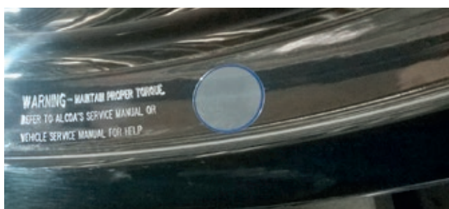
Zdjęcie 13-4 Wskaźnik wysokiej temperatury, wersja 2 na kołnierzu felgi
