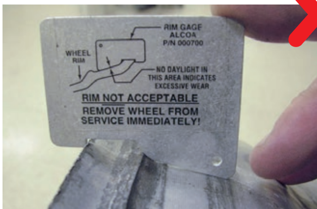
Zdjęcie 13-28 STAN NIEDOPUSZCZALNY
