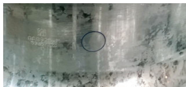
Zdjęcie 13-5 Wskaźnik wysokiej temperatury, wersja 2, w zagłębieniu felgi obok numeru seryjnego i otworu na zawór
