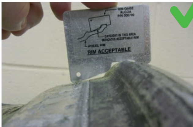
Zdjęcie 13-27 STAN DOPUSZCZALNY
