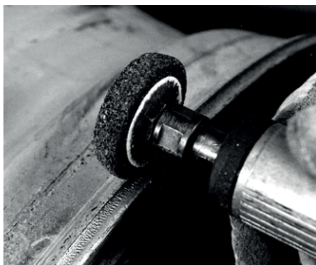
Zdjęcie 13-32 Szlifierka pneumatyczna lub elektryczna Kolejna szybka i skuteczna metoda usuwania ostrych krawędzi kołnierzy felg, powstałych w wyniku zużycia kołnierzy felg. Należy zachować ostrożność, ponieważ drobiny tarczy szlifierskiej mogą „strzelać” przy kontakcie z usuwanym aluminium. Należy uważać, aby nie uszkodzić felgi.
