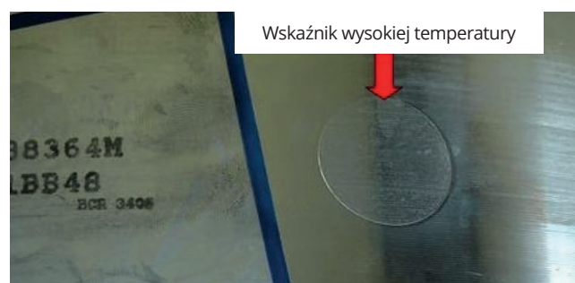
Zdjęcie 13-3 Wskaźnik wysokiej temperatury w zagłębieniu felgi
