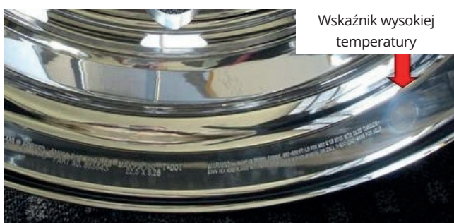
Zdjęcie 13-2 Wskaźnik wysokiej temperatury na kołnierzu felgi
