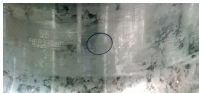
Figura 13-5 Indicador de calor, versão 2, na cuba da jante, junto ao número de série e orifício da válvula
