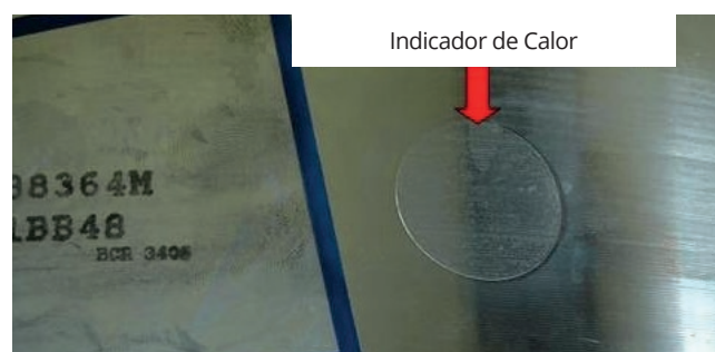
Figura 13-3 Indicador de calor na cuba da jante
