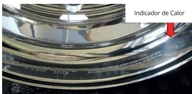
Figura 13-2 Indicador de calor no flange da jante
