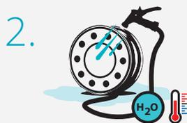
2. Enxaguar a jante com água para evitar riscos e erosão; de preferência com uma máquina de limpeza a alta pressão.
