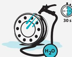
Enxaguar a jante com água para evitar riscos e erosão.
