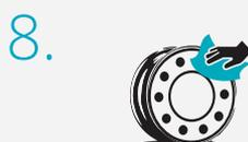
8. Espalhar uniformemente sobre a jante com um pano húmido e polir a roda.
