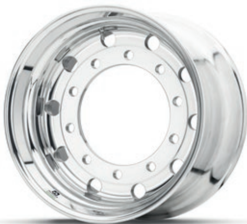
Imaginea 13-19 Jantă care poate fi montată o singură dată
