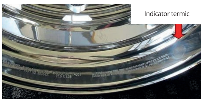
Imaginea 13-2 Indicator termic pe flanșa jantei
