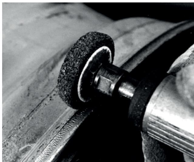
Imaginea 13-32 Polizor pneumatic sau electric O altă metodă rapidă și eficientă de îndepărtare a marginii ascuțite cauzate de uzura flanșei jantei. Aveți grijă, deoarece pânzele de șlefuit pot „degrada” aluminiul care este îndepărtat. Evitați smulgerea jantei.
