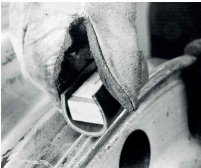
Bild 13-29 Skarphetsmätare av gummi eller en lämplig bit gummi som fästs på ett träblock.
