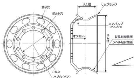
アルコア鍛造アルミホイールの名称図と、製品刻印表示例です。製品の確認やバルブ交換の際にご参照ください。
