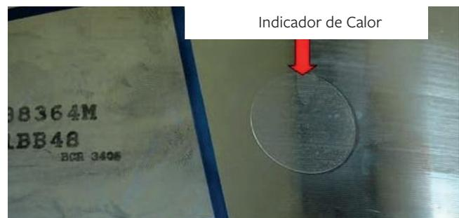
Foto 13-5 Indicador de calor versão 2 na cuba da roda, perto do número de série e do orifício da válvula
