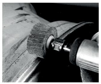
Foto 13-34 Retífica elétrica ou pneumática Outro método rápido e eficaz para remover a aresta afiada causada pelo desgaste dos flanges do aro. Tenha cuidado porque o disco da retífica pode "travar" com o alumínio que é removido. Evite fazer sulcos na roda.
