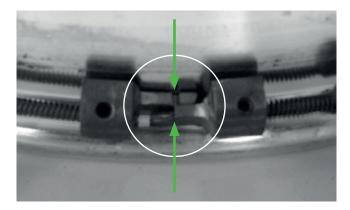
Se a circunferência do assento do talão não corresponder à dimensão necessária indicada pela fita métrica esférica, retire a roda de serviço imediata e permanentemente e descarte-a.
