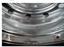
Foto 13-9 Indicador de calor carbonizado próximo à estampa, 2009 em diante Foto 13-10 Indicador de calor carbonizado próximo à estampa, 2009 em diante (visto de perto)
