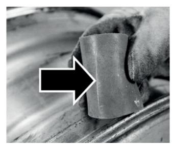
Ao passar o medidor de afiação ao longo da roda na área do desgaste, determine se o desgaste está afiado o suficiente para cortar ou danificar a borracha do medidor de afiação. Se a borracha for cortada, siga as instruções de remoção de arestas descritas na Seção 13.g.iii.
