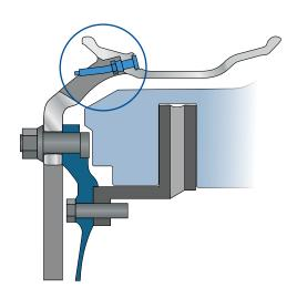
Figura 4-1 Válvula externa
