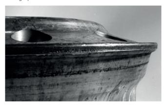
Retire as rodas de serviço quando o desgaste dos flanges do aro for excessivo. O desgaste excessivo pode ser determinado usando-se um medidor de desgaste aprovado pela Howmet Aerospace e os procedimentos detalhados na Seção 13.g.ii.
