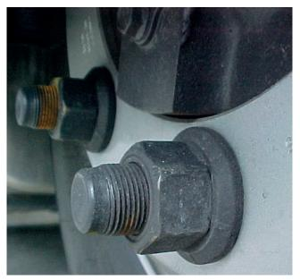
Alguns fabricantes de veículos oferecem eixos com prisioneiros "combinados" ou extralongos, adequados tanto para rodas de aço, com disco mais fino, quanto para rodas de alumínio, com disco mais espesso. Em alguns casos, as Rodas Alcoa® podem ser montadas sem substituir os prisioneiros ou sem o uso de porcas com manga. Para determinar a instalação correta e segura, siga o procedimento descrito nesta Seção.
