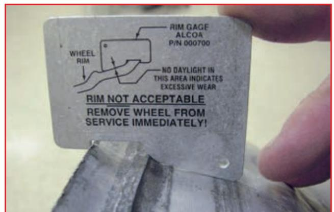
Foto 13-31: Passe o medidor de afiação ao longo da roda na área do desgaste para determinar se esse desgaste está afiado a ponto de cortar ou danificar a borracha do medidor de afiação.
