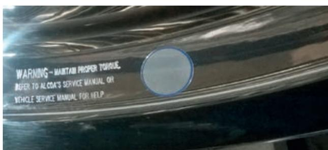
Foto 13-3 Indicador de calor na cuba da roda
