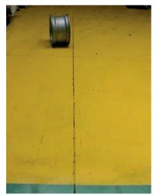
Se não houver fita métrica esférica nem esquadro de carpinteiro, role a roda sem pneu por, no mínimo, 10 pés ou 3 metros sobre uma superfície lisa, plana, horizontal e limpa, como um pavimento de asfalto ou concreto. Se ela não rolar em linha reta, isso indica uma possível ausência de contorno e dimensões adequados. Retire a roda de serviço até que ela possa ser devidamente verificada com uma fita métrica esférica.
