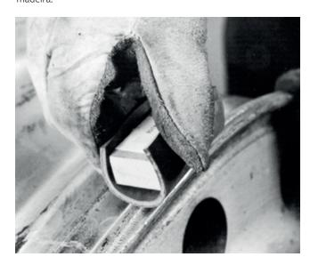
Foto 13-31: Passe o medidor de afiação ao longo da roda na área do desgaste para determinar se esse desgaste está afiado a ponto de cortar ou danificar a borracha do medidor de afiação.
