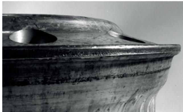
Retire as rodas de serviço quando o desgaste dos flanges do aro for excessivo. O desgaste excessivo pode ser determinado usando-se um medidor de desgaste aprovado pela Howmet Aerospace e os procedimentos detalhados na Seção 13.g.ii.
