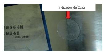
Foto 13-5 Indicador de calor versão 2 na cuba da roda, perto do número de série e do orifício da válvula
