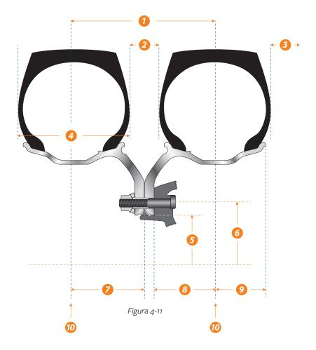
As Rodas Alcoa<sup>®</sup> que podem ser montadas em posição dupla indicam a Metade do Espaçamento Duplo (Half Double Spacing – HDS) depois da dimensão da roda (por exemplo, 22.5 x 9.00 - 176) na estampa. Isso significa que a HDS é 176, medido em milímetros.
